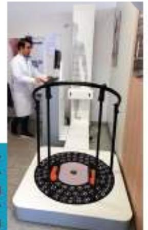
Der Körperz scanner Bodytronic® von Bauerfeind misst besonders exakt mithilfe von 3D-Messtechnik. Der Messvorgang ist nicht nur besonders angenehm, sondern auch sehr schnell. Die Vermessung verläuft absolut berührungsfrei und sorgt für eine hohe Passgenauigkeit.
